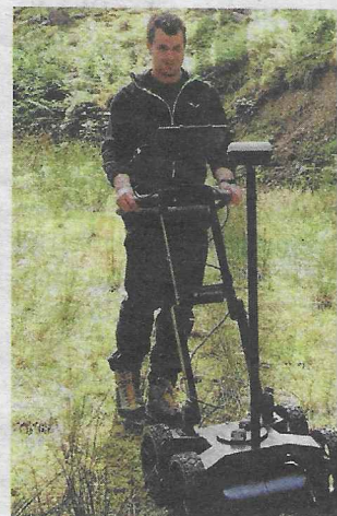
Mit dem Georadargerät kann er bis zu 10 Meter in die Tiefe blicken.
